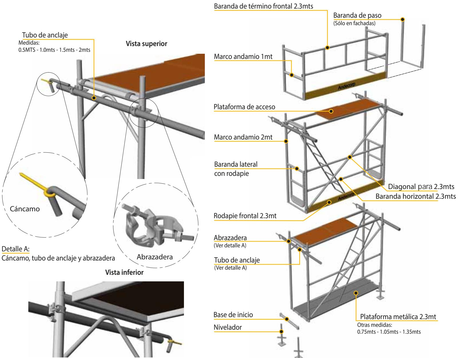
Especialmente diseñado para obras civiles que requieran trabajos en superficies rectangulares.
